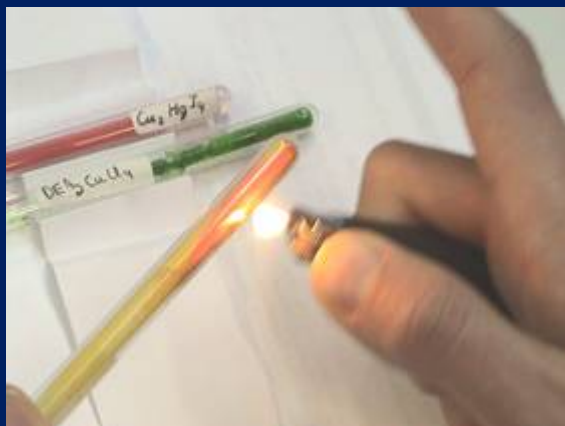
Поведение при нагревании: \text{Ag}_2\text{HgI}_4 (слева) и \text{Cu}_2\text{HgI}_4 (справа)
