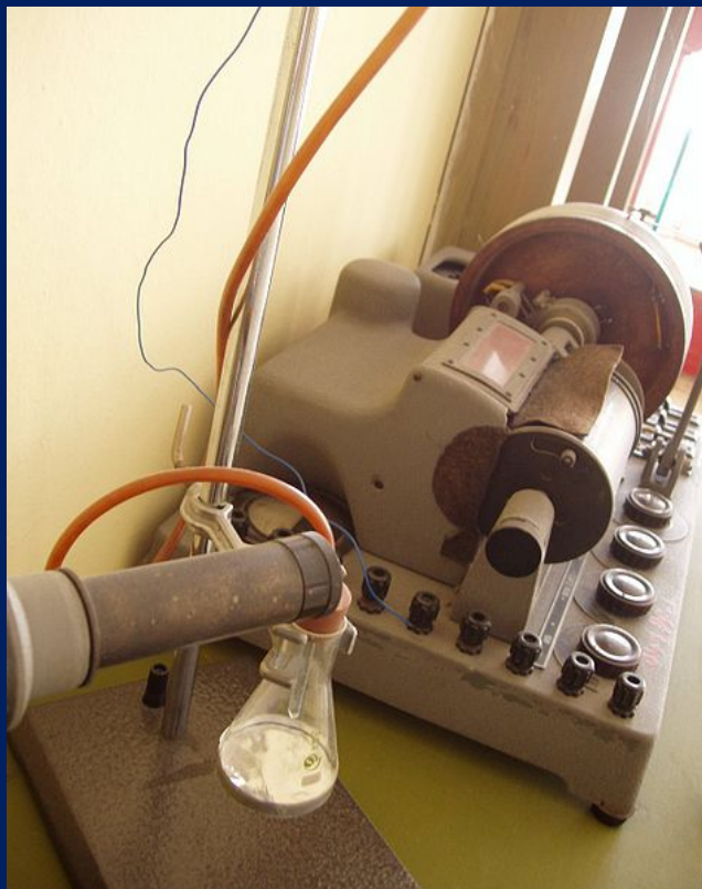
Полярграф Я. Гейровского – первооткрывателя метода полярграфии wikipedia.org
