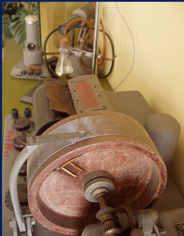
Полярграф Я. Гейровского – первооткрывателя метода полярграфии wikipedia.org
