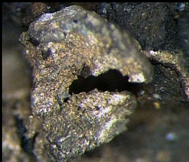
Алларгентум - сплав серебра и сурьмы (Allargentum) Ag_{1-x}Sb_x , где x = 0.09 - 0.16
